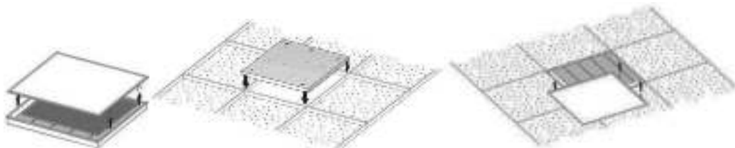
Рисунок 5 — Установка светильника Geniled серии Грильято на подвесную конструкцию.
